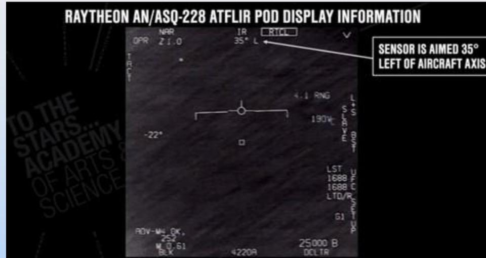
Ces images ont été capturées par un Super Hornet F/A-18 de l'US Navy qui était doté de l' ATFOIR (Advanced Forwarding Looking Infrared) AN / ASQ-228 qui est un module de ciblage électro-optique multicapteur comprenant une caméra thermographique, une caméra de télévision à faible luminosité, un télémètre/laser et un laser tracker développé et fabriqué par Raytheon.
